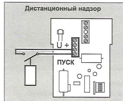
Приводом Z 74 A можно управлять дистанционно при помощи реле с перекидными "сухими" контактами (например, реле Honeywell Centra Bürkle типа REL 2). Минимальное время удержания контактов реле для активизации обратной промывки составляет одну секунду.
