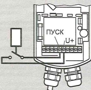
Функцией обратной промывки можно по мере необходимости управлять при помощи реле перепада давления DDS 76 с микропереключателем, имеющим "сухие" контакты. Рекомендуется устанавливать перепад давления на уровне 1,0 бар.
