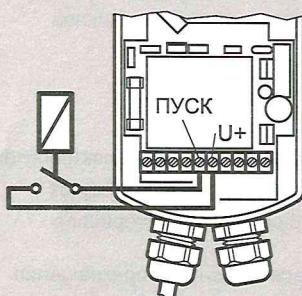
Приводом Z 11 S можно управлять дистанционно при помощи реле с перекидными "сухими" контактами (например, реле Honeywell Centra типа REL 2). Минимальное время удержания контактов реле для активизации обратной промывки составляет одну секунду.
