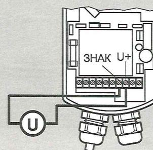
Для дистанционного контроля открытого или закрытого положения шарового клапана рекомендуется использовать центральную систему сигнализации с входным напряжением от 0 до 10 В. Максимальный допустимый ток равен 10 мА. Величина сигнала на уровне от 5 до 10 В указывает на присутствие сетевого тока и на то, что выпускной клапан закрыт.
