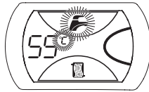
Рис. 5 Индикация настройки температуры ГВС
