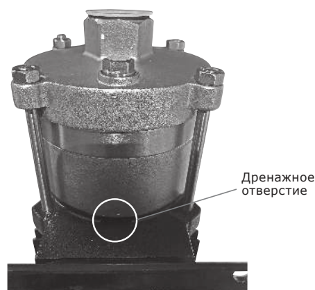
Рис. 11 Дренажное отверстие торцевого уплотнения
