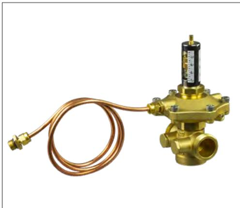
Клапаны балансировочные автоматические APT-R — регуляторы перепада давления, предназначенные для гидравлической балансировки трубопроводных систем тепло- и холодоснабжения при переменных расходах проходящей через них среды в диапазоне от 0 до 100 %.
