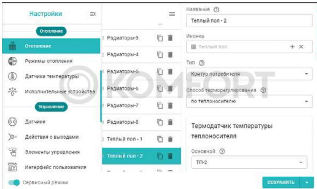
Контур ГВС – это разновидность отопительного контура со специальными возможностями управления, характерными только для горячего водоснабжения.
