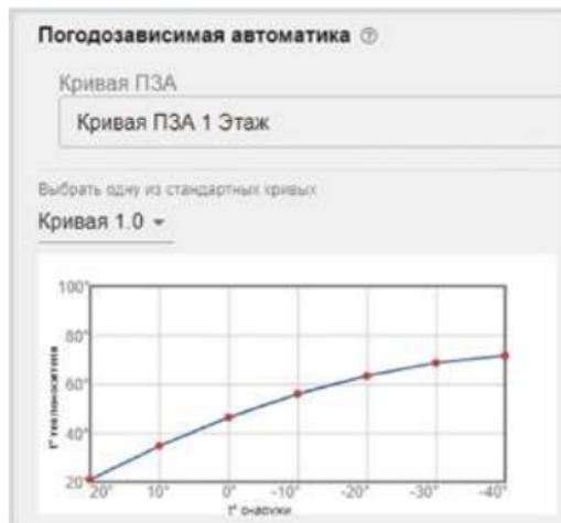
Существует возможность изменения целевой температуры для контура– это приведет к сдвигу выбранной кривой отопления. Например, если в помещении нужно поддерживать 23 °С – необходимо сдвинуть кривую относительно изначального графика вверх, если необходима целевая температура воздуха 17 °С – кривую нужно сдвинуть вниз. Вид графиков со сдвигом представлен на рисунке ниже.
