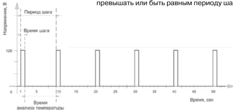
Управление поворотным приводом (тип – «**Трёх-ходовой кран**») производится за счет чередования импульсов на открытие и закрытие с настраиваемыми длительностью и периодом их повторений. Для управления таким приводом используются 2 релейных выхода контроллера: одно реле – для открытия, второе – для закрытия.
