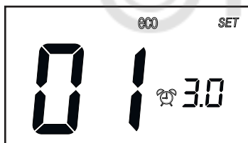
Рис. 11. Настройка времени задержки пуск котла в Эко-режиме.
