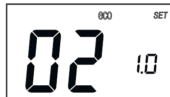
Рис. 12. Настройка отопительной кривой
