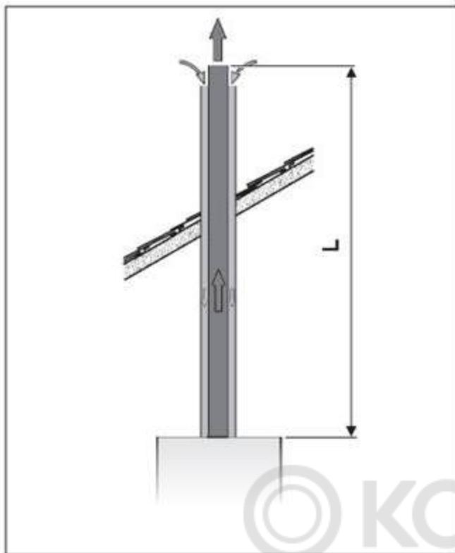
Рис. 8 Вертикальный отвод дымовых газов через концентрическую трубу С 32
