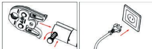
Нажмите на концы пресс-насадки, тем самым открыв губки клещей. Для выполнения пресс-соединения установите пресс-насадку на фитинг так, чтобы монтажный буртик фитинга совпал с соответствующей канавкой пресс-насадки. Обратите внимание, чтобы не было перекоса между осью инструмента и осью пресс-насадки – это может привести к опасным повреждениям.
