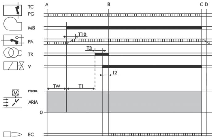
**TW** Начинается при замыкании линии термостатов и PG. Реле PA должно находиться в исходном положении. Это время на ожидание и автоматического контроля.
