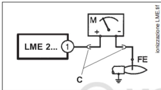
Минимальный ток ионизации, требуемый для функционирования оборудования — 5  $\mu$ А. Горелка вырабатывает ток намного выше. И обычно не требуется никакой проверки. Если потребуется измерить ток ионизации, соедините последовательно микроамперметр с проводом электрода ионизации, отсоединив зажим "1" (см. эл. схему подключения LME 22), как показано на рисунке.
