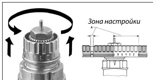
На настроечном устройстве клапана указаны положения настройки от «1» до «7» и буква «N». Настройка может быть выполнена быстро и точно без применения какого-либо инструмента, для этого необходимо:
