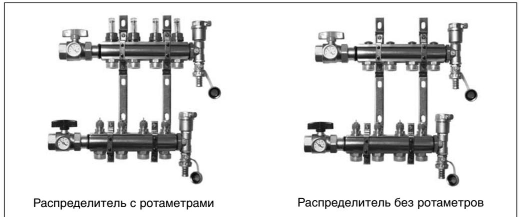
Распределительный коллектор FHF используют для регулирования подачи теплоносителя в системах напольного отопления. Трубопровод каждого из контуров напольного отопления подключают к отдельной паре присоединительных штуцеров распределителя, что даёт возможность регулировать расход теплоносителя, а, соответственно, и тепловую мощность системы в каждом помещении здания индивидуально.
