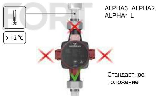
Рис. 17 Возможное положение блока управления для системы отопления
