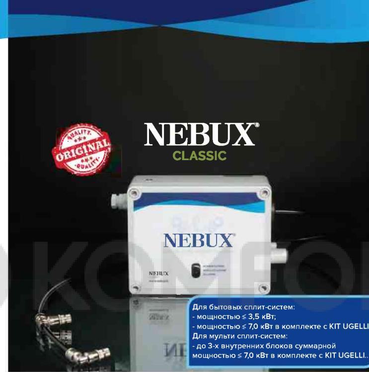
**NEBUX Classic** совместим с бытовыми кондиционерами и мульти сплит-системами. В состав насоса входят фильтр грубой очистки на входе, фильтр со стороны всасывания и несколько защит электрических и электронных частей. Также имеется аварийный выход реле (с контактами NO), который активируется при аварии и может использоваться для отключения кондиционера.
