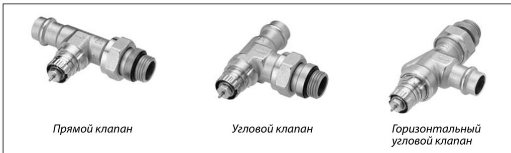
Клапан RA-N предназначен для применения в двухтрубных насосных системах водяного отопления с трубопроводами из меди или нержавеющей стали. Для соединения штуцера клапана с трубопроводом требуются специальные обжимные инструменты.
