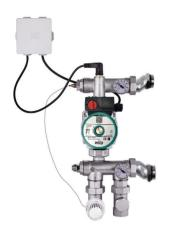
Насосно-смесительный блок в комплекте с термостатической головкой для поддержания постоянной температуры на подаче в системе напольного, настенного и потолочного отопления. Для арт. 1135960 насос следует приобретать отдельно: монтажная длина - 130 мм, насос с наружной резьбой 1 1/2" НР.
