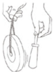
Рис. 5. Проверка абразивного круга
