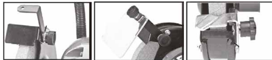
Рис. 2. Установка упоров и защитных экранов
