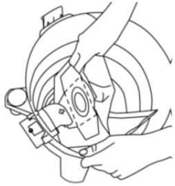
Установка бумажного мешка
