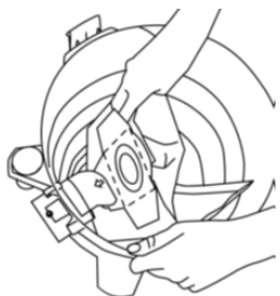
Установка бумажного мешка
