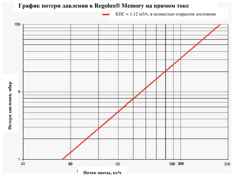
График потери давления в Regolux® Memory на прямом токе
