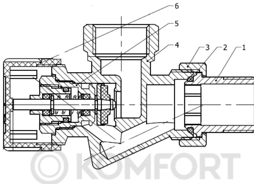
Транспортируемая среда поступает в корпус (4) со стороны внутренней резьбы. Выходит со стороны штуцера (1), который присоединяется к корпусу (4) с помощью накидной гайки (3). Уплотнение штуцера с корпусом происходит за счет уплотнительного кольца из EPDM (2).
