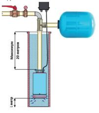
**ВНИМАНИЕ!** Никогда не используйте шнур питания для подъема насосов. Максимальная глубина погружения насосов 20 метров (ниже уровня воды). При использовании насосов на максимальной глубине, рекомендуется крепить силовой кабель к напорной трубе хомутами через каждые два/три метра.
