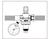
Правильная установка клапана автоматической подпитки предусматривает монтаж шарового крана до и после него. Выходом клапан автоматической подпитки подключается к системе отопления, входом – к системе водоснабжения.
