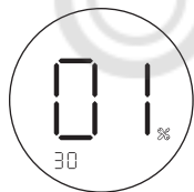
Рис. 13. Настройка времени задержки пуск котла в Эко-режиме.
