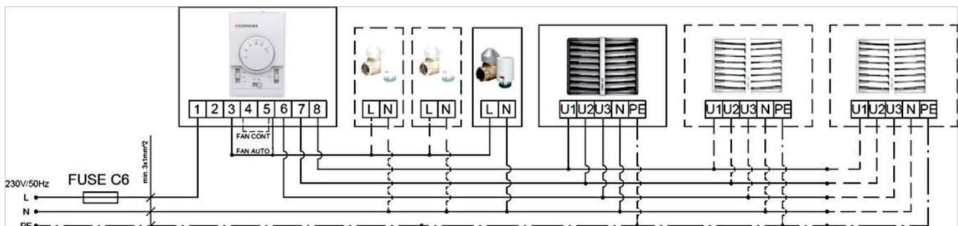
**13.3. Подключение CR с автоматической панелью управления INTELLIGENT**
