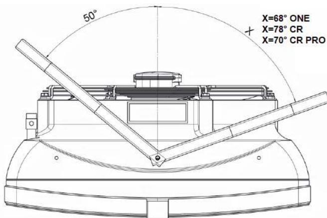
Тепловентилятор может поворачиваться относительно монтажного кронштейна в горизонтальной плоскости. Чтобы сделать это, вы должны смонтировать CR к гибкой подводке, в этом случае максимальный угол поворота CR по отношению консоли в горизонтальной плоскости составляет 70° для CR PRO, 78° для CR1, CR2, CR3, 68° - для CR ONE. X - максимальный угол поворота в сторону противоположную от патрубков и угол 50° на сторону патрубков, сохраняя достаточное пространство для подключения к трубопроводу
