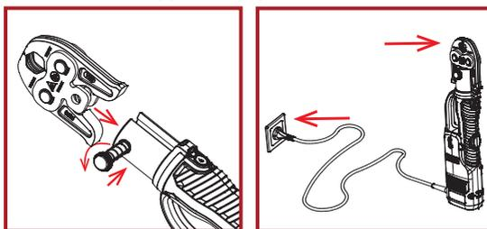
Нажмите на концы пресс-насадки, тем самым открыв губки клещей. Для выполнения пресс-соединения установите пресс-насадку на фитинг так, чтобы монтажный буртик фитинга совпал с соответствующей канавкой пресс-насадки. Обратите внимание, чтобы не было перекоса между осью инструмента и осью пресс-насадки – это может привести к опасным повреждениям.
