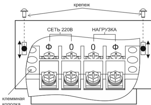
Рисунок 3 – Схема подключения к клеммной колодке
