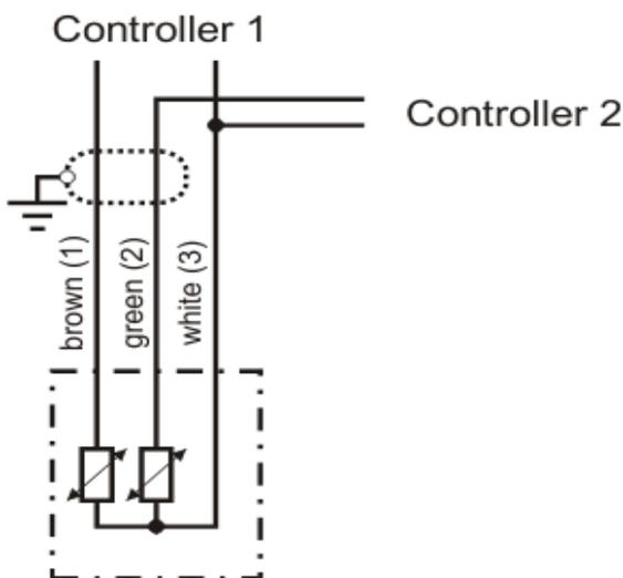
Монтаж датчиков с 2-мя элементами для 2-х контроллеров
