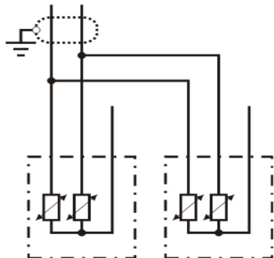
Усреднения измеренного значения двумя КТФ 20
