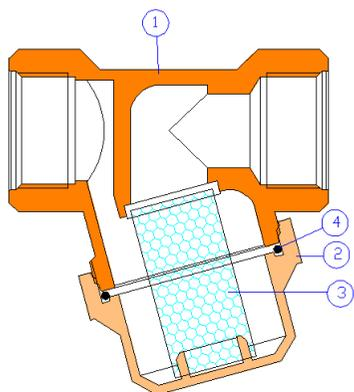
Фильтр состоит из корпуса 1, заглушки 2, фильтроэлемента 3 и уплотнительного кольца 4. Корпус и заглушка фильтра выполнены из горячепрессованной латуни марки CW617N (ЛС59-2) с гальванопокрытием из никеля.
