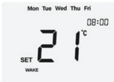
При программировании будних дней/выходных на экране отображается «Mon Tue Tue Wed Thu Thu Fri» (пн, вт, ср, чт, пт).
