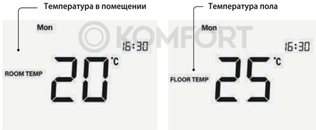
*Примечание: для управления электрическим напольным отоплением НЕ ДОЛЖЕН использоваться только встроенный датчик воздуха. Необходимо использовать только датчик температуры пола или встроенный датчик температуры воздуха и температуры пола вместе.*
