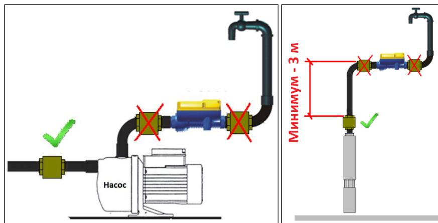
Не рекомендуется устанавливать устройство BRIO-TOP внутри скважин или герметичных коробок, там, где может возникать обильная конденсация влаги и воздуха.
