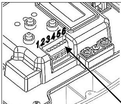
Устройство BRIO-TOP оснащено клеммной панелью, при помощи которой становятся доступны вспомогательные контакты, позволяющие производить соединения BRIO-TOP с другими внешними приборами.
