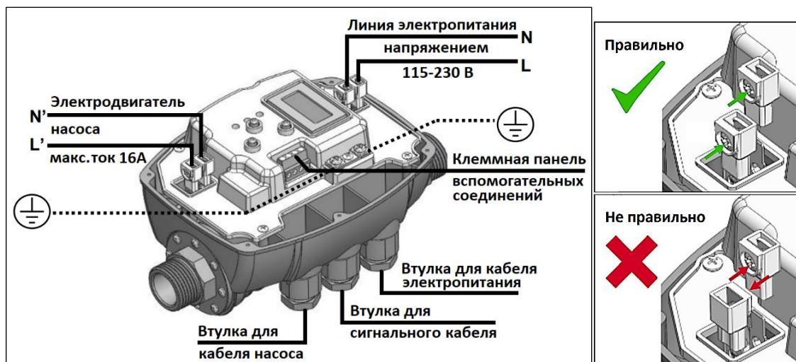
Перед электродвигателями насосов должны устанавливаться автоматы тепловой защиты. При использовании насоса в системах водоснабжения бассейна, фонтана и т.п. питание к устройству для его управления необходимо подключать через защитный автомат УЗО с током срабатывания 30 мА.
