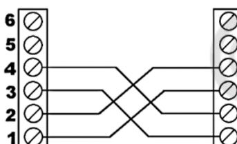
Соединение между устройствами Brio Top может быть выполнено при помощи экранированного кабеля  $4 \times 0,5 \text{ мм}^2$ , как показано на схеме рядом. Максимальная длина кабеля составляет 100 см, включая оголенные части.
