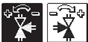
В меню выбора направление открытия смесительного клапана, выбор производится с помощью клавиш (+) и (-). Выбранное направление подтверждается нажатием клавиши (✓).
