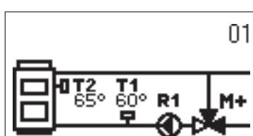
В меню выбора гидравлической схемы для работы регулятора, перемещение по схемам производится с помощью клавиш (+) и (-). Выбранная схема подтверждается нажатием клавиши (✓).
