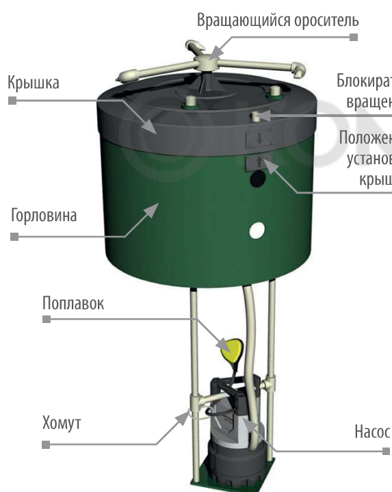
Рисунок 17. Установка циркуляционного насоса Станции.
