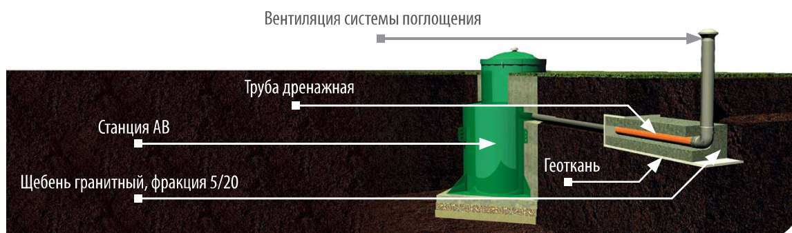
Рисунок 8. Система поглощения, поле поглощения.
