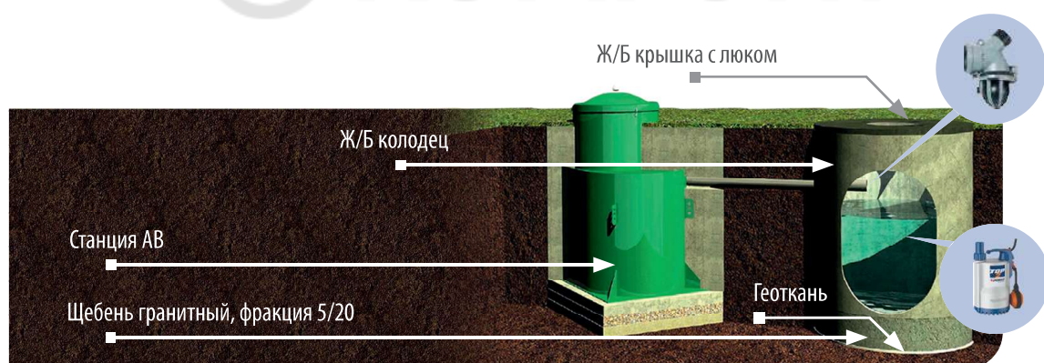
Рисунок 7. Система поглощения, колодец поглощения.
