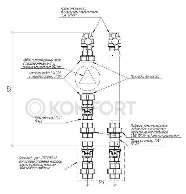
\* Допускается изменение порядка подающей и обратной линии, в том числе и для использования насосной группы на котловом контуре (в этом случае насос необходимо установить на обратной линии котла, для поддержания избыточного давления и снижения вероятности недообмыва и закипания котла при аварийных ситуациях)
