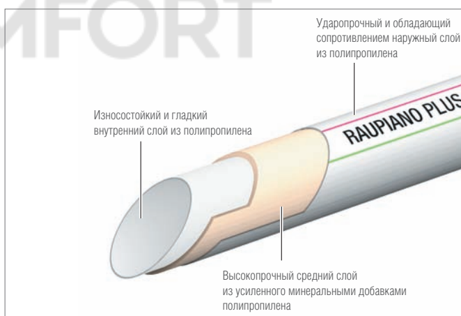
Рис. 2-3 Конструкция трубы RAUPIANO PLUS
