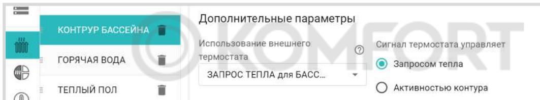
При такой настройке, появление на входе дискретного сигнала, будет формировать “запрос на тепло” котловому контуру, т.е. включать котел в нагрев. **Целевая температура** нагрева теплоносителя задается с панели контура на вкладке “Отопление”.
