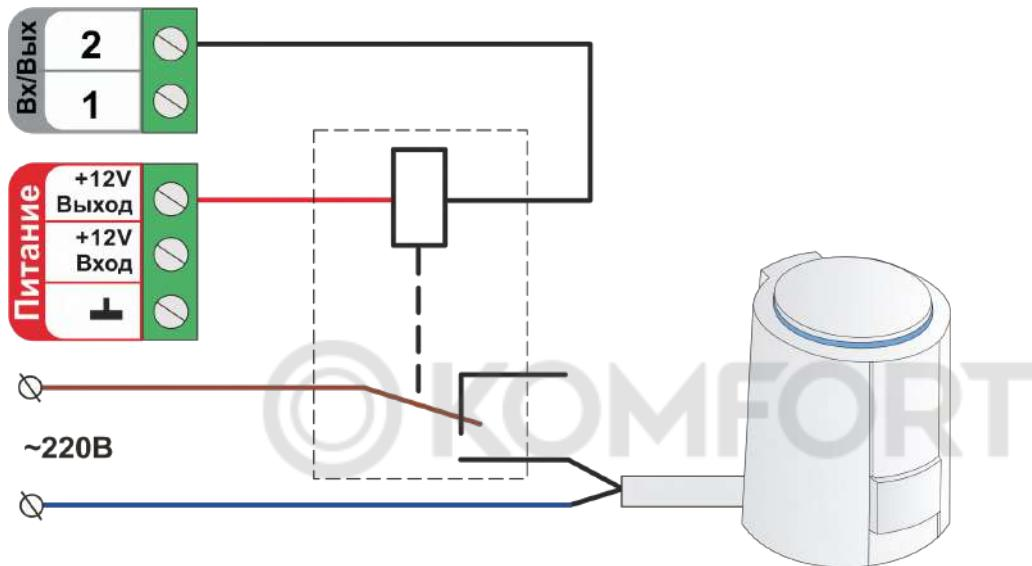
**Примечание:** Выход ОК аппаратно защищен от перегрузки при подключении индуктивной нагрузки.
