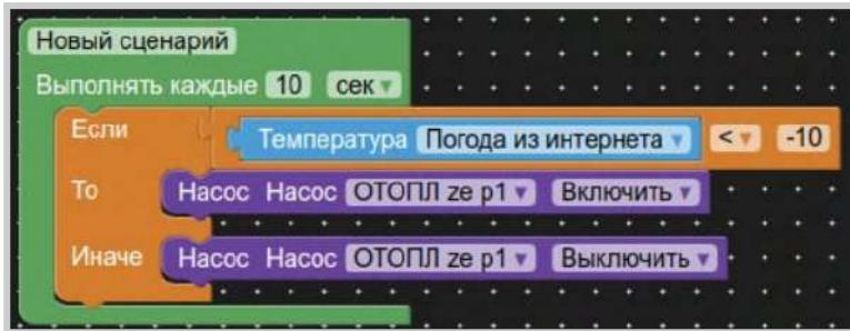
**Пример:** Задача: Включать насос, когда температура на улице опускается ниже -10°C. Результат: Контроллер каждые 10 секунд проверяет условие и при его истинном значении включает насос. Если условие ложно – выключает насос.
