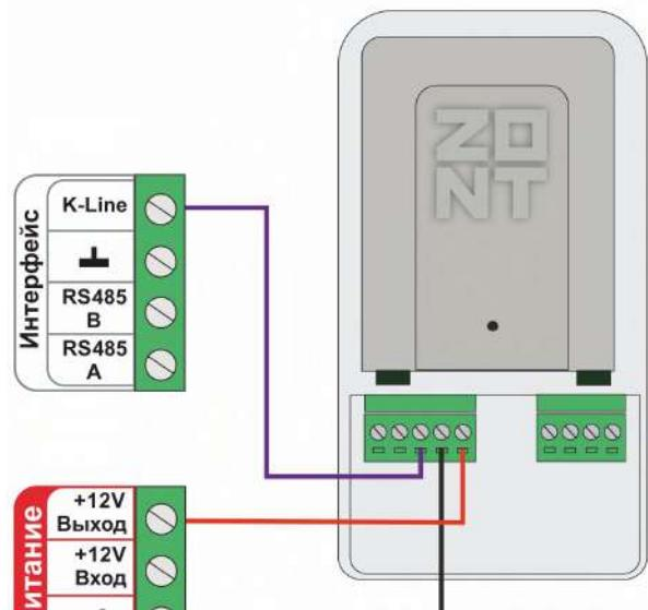
Схема подключения внешнего адаптера цифровой шины **DIN** по **RS-485**:
