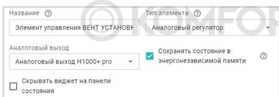
При этом в сервисе, в блоке Управление и Статус будет отображен Элемент управления аналоговым выходом 0-10В. Перемещая ползунок шкалы напряжения, можно менять напряжение на аналоговом выходе и тем самым управлять работой исполнительного устройства вручную.
