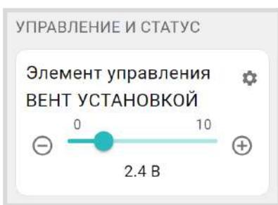
**Примечание:** Если аналоговый выходом 0-10В управляет Исполнительным устройством используемом в котловом или отопительном контуре, то перемещение движка вручную изменит напряжение на выходе, но оно не сохранится, т.к. алгоритм управления отоплением вернет напряжение в то значение, которое необходимо по алгоритму.
