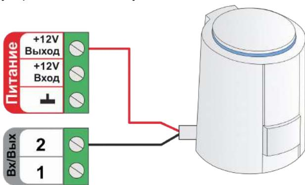
Схема подключения исполнительного устройства к релейному выходу:
