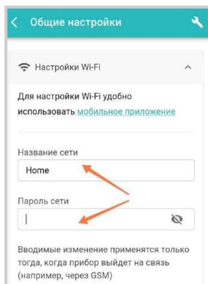
Если в Контроллер уже установлена активная SIM-карта, осуществляющая передачу мобильных данных, и связь с сервером по каналу GSM установлена, то для подключения к сети Wi-Fi достаточно указать название и пароль этой сети на вкладке “Общие настройки”, и перезагрузить Контроллер. Прибор разорвет соединение с сервером по каналу GSM и установит соединение по каналу Wi-Fi, который станет основным каналом связи, а GSM канал станет резервным.
