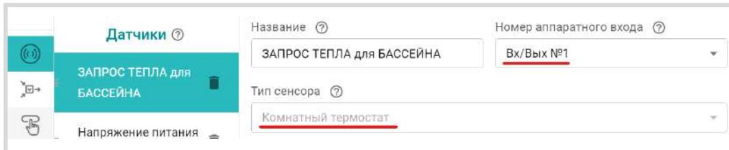
В настройке контура бассейна указать, что “Сигнал термостата управляет **Запросом тепла**”
