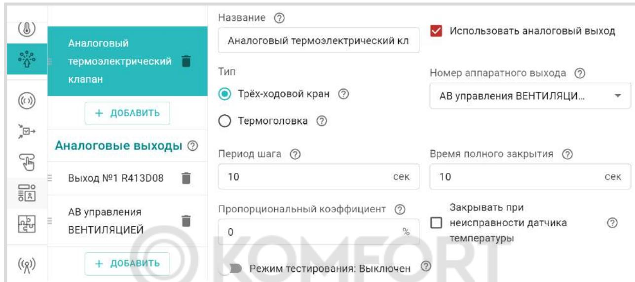
**ВНИМАНИЕ!!!** Тип исполнительного устройства **Трёхходовой кран** используется вне зависимости от того, какое именно устройство управляет контуром термоэлектрический клапан (термоголовка) или трехходовой (двуухходовой) кран.
