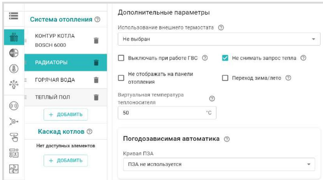
**Использование внешнего термостата** – параметр для настройки контура со сторонним устройством управления с дискретным выходным сигналом. На панели такого контура отображается символ термостата
