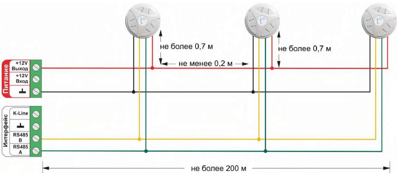
Подключение нескольких датчиков по K-Line:
