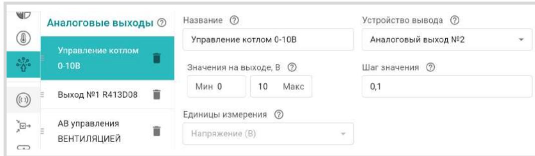
В котловом контуре выбрать этот аналоговый выход в качестве исполнительного устройства
