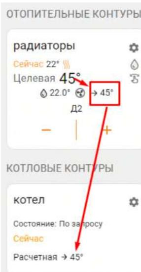
Теперь, при запросе тепла к котловому контуру, значение расчетной температуры теплоносителя будет преобразовано в управляющее напряжение (Вольты) и через аналоговый выход поступит в котел для выполнения.
