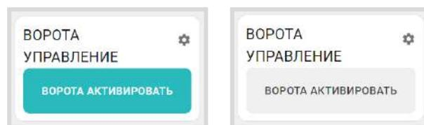
Элементы управления отображаются сервисом отдельным блоком “Управление и Статус”. Активное состояние элемента управления выделяется цветом.
