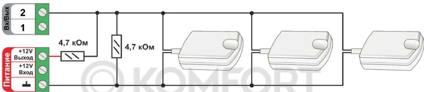
**ВНИМАНИЕ!!!** Датчики протечки Астра 361 имеют полярность. Полярность указана в документации на датчики. При несоблюдении полярности датчик не имеющий контакта с водой показывает сработку.
