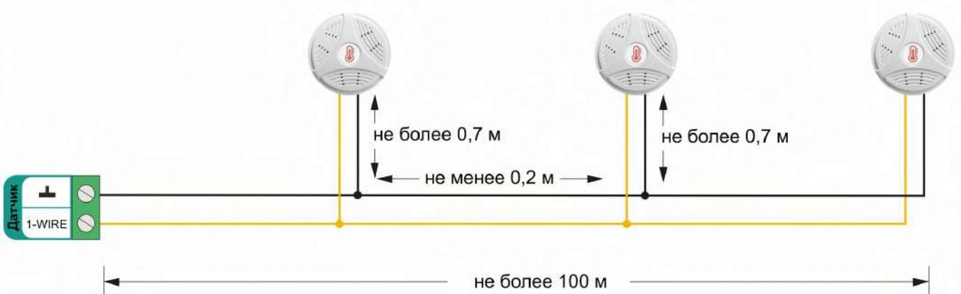
Подключение датчиков по трехпроводной схеме:
