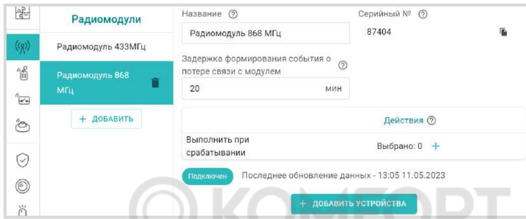
Для обмена данными по радиоканалу 868 МГц используется оригинальный цифровой протокол ZONT, соответственно могут быть подключены только оригинальные датчики ZONT:
