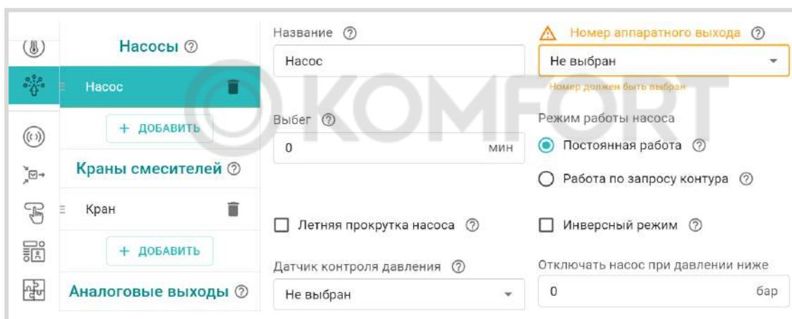
При выборе параметра **Постоянная работа** насос работает всегда и выключается только:
