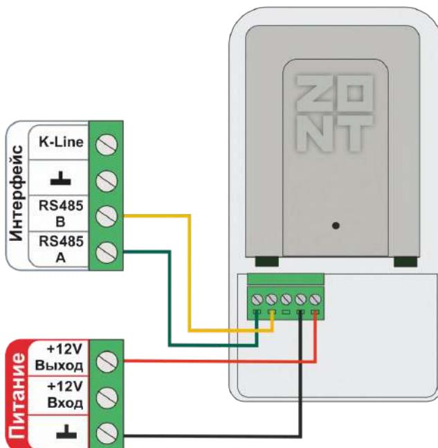
Схема подключения радиомодуля по K-Line:
