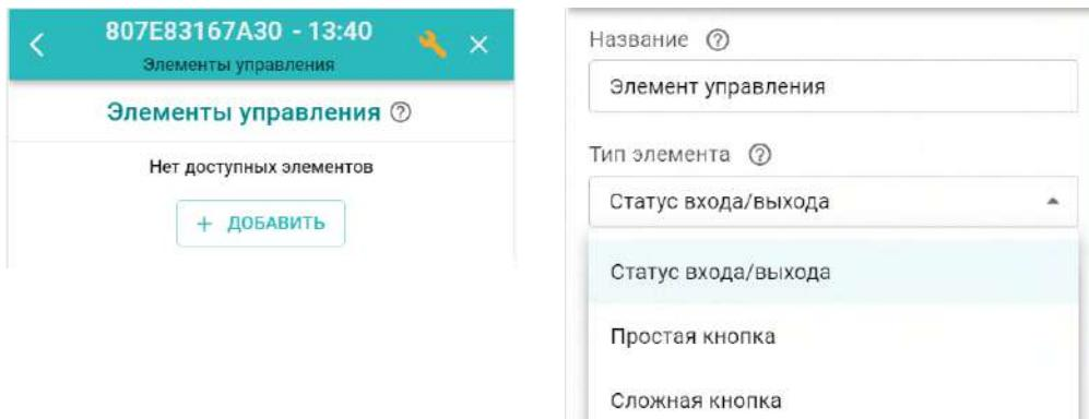
Элемент управления может быть “Статусом входа или выхода” и отображать текущее состояние универсального входа или релейного выхода Контроллера.
