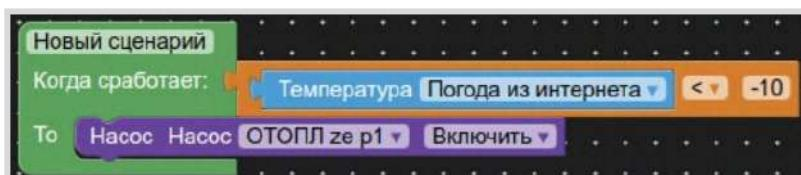
**Пример:** Задача: включить насос, когда температура на улице опустится ниже -10°C. Результат: когда температура упала до -10,1°C сценарий выполнится. Повторное включение насоса сработает когда температура на улице поднимется до -9°C, и снова опустится ниже -10°C.
