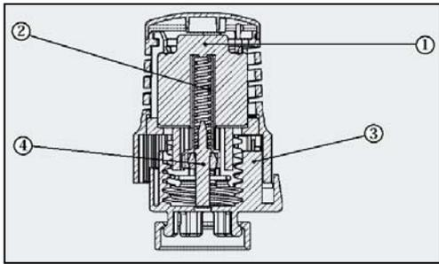
1. Жидкостный чувствительный элемент;
