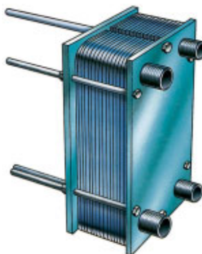
4. В опорную и прижимную плиты вставляются стяжные болты, и с помощью гаечного ключа (или другого подходящего инструмента) пакет пластин (в соответствии с техническими условиями) стягивается в единый герметичный узел теплообменника.
