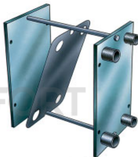
2. Первой устанавливается на раме концевая теплообменная пластина.
