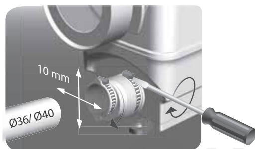
Рис. 35 При использовании подводящих трубопроводов Ø36/40 возможно боковое выравнивание и выравнивание по высоте
