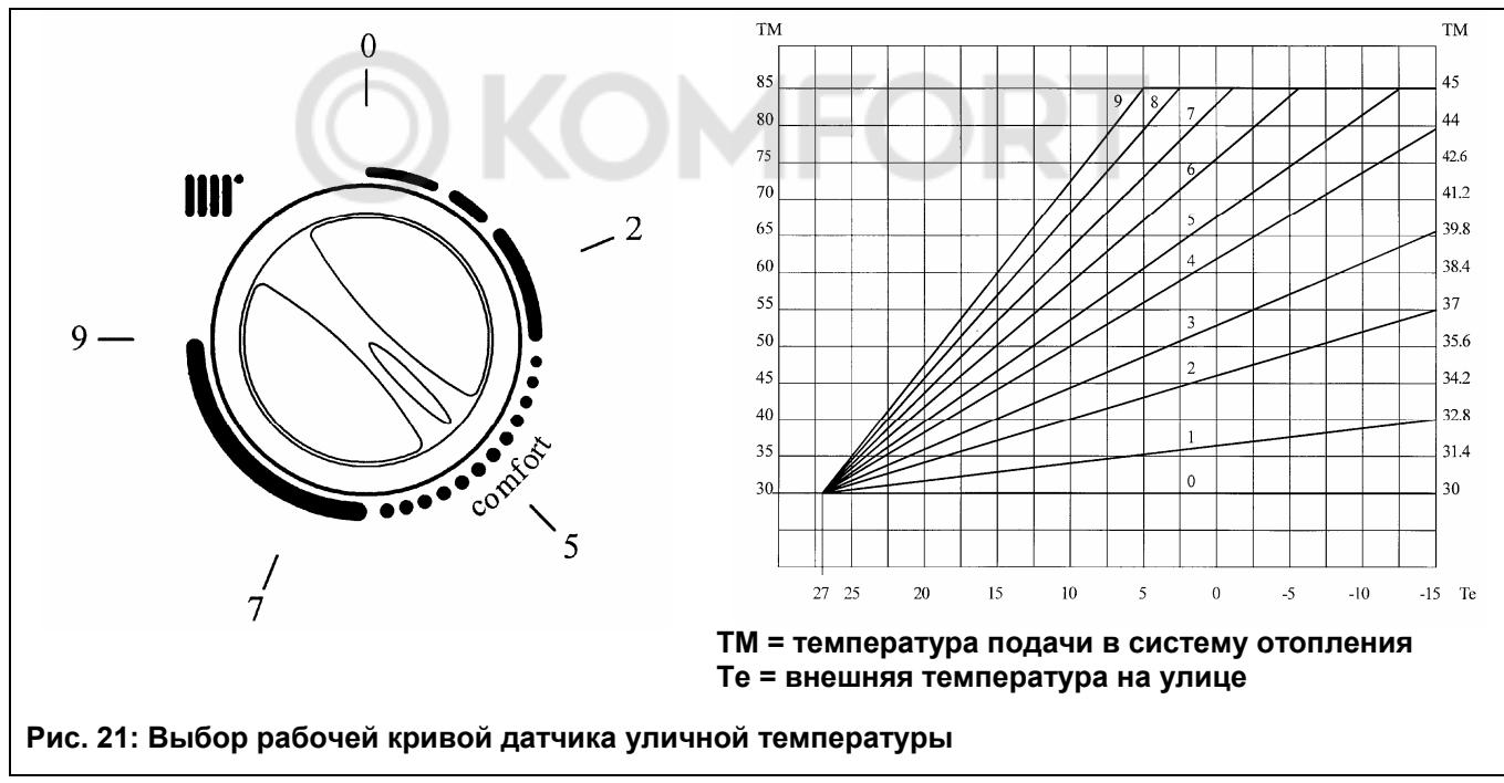
Рис. 21: Выбор рабочей кривой датчика уличной температуры
