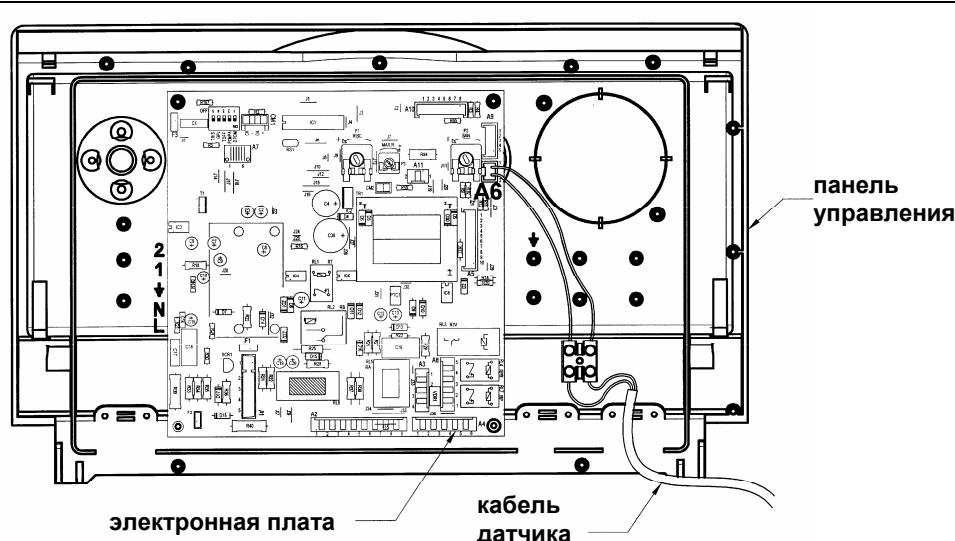
Рис. 20: Присоединение датчика уличной температуры
