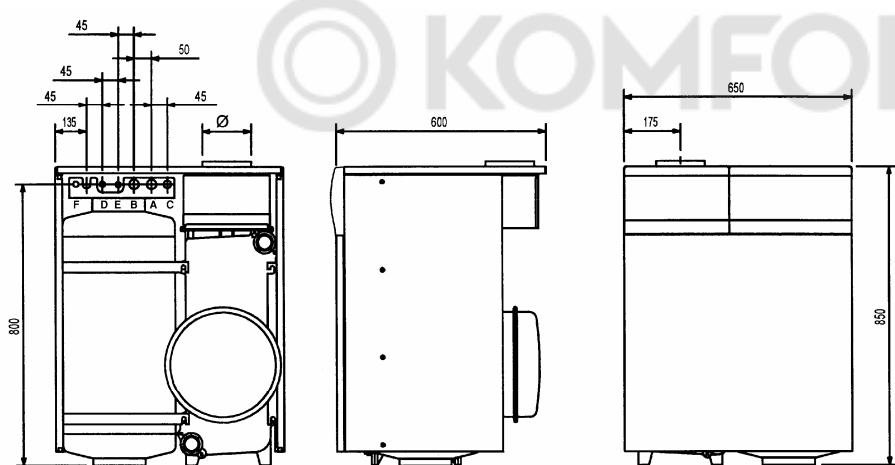
2.230 i — диаметр дымоотводящего патрубка = 130 мм
