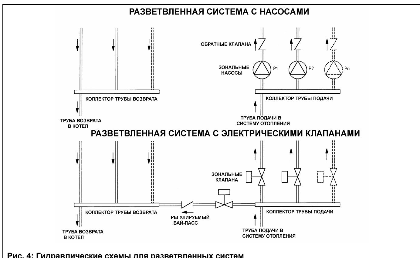
Рис. 4: Гидравлические схемы для разветвленных систем
