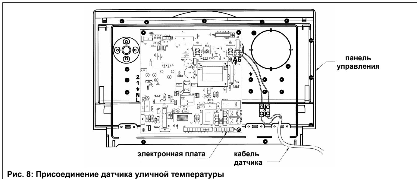
Рис. 8: Присоединение датчика уличной температуры
