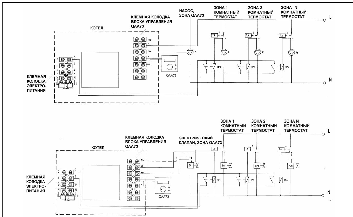
Рис. 7: Электрические схемы работы зональных систем, подачи питания на насосы и клапана
