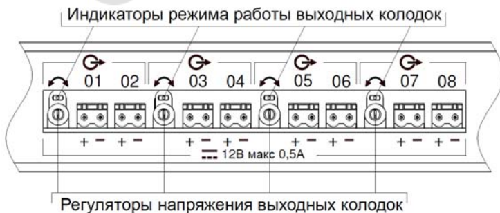
Рисунок 2 - описание коммутационных элементов преобразователя напряжения PN-V.8
