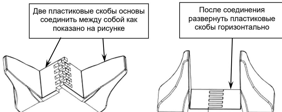
Рисунок 4 — Сборка пластиковых основ для вертикальной установки изделия
