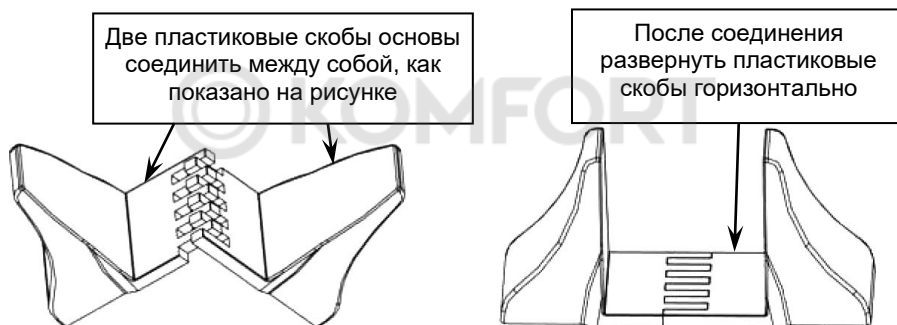
Рисунок 4 - Сборка пластиковых основ для вертикальной установки изделия.
