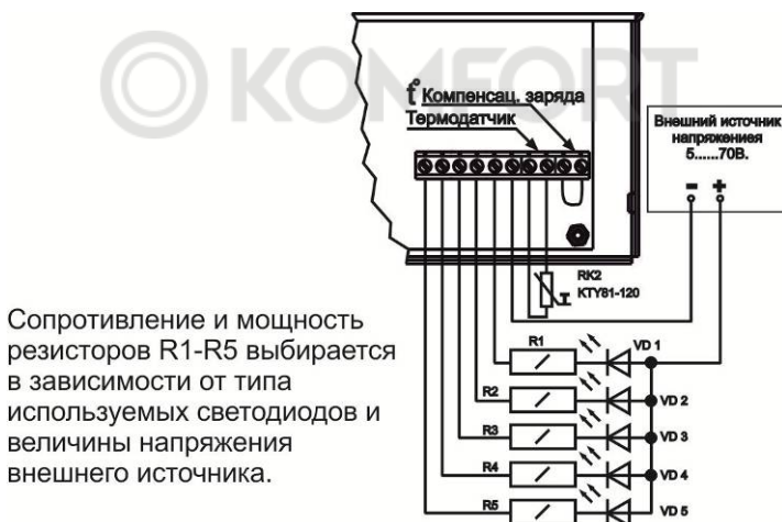
Рисунок 7 – подключение внешних цепей индикации
