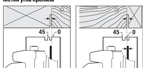
Метка угла пропила **0° 8** показывает положение пильного диска при распиле под прямым углом. Метка угла пропила **45° 7** показывает положение пильного диска при распиле под углом  $45^\circ$ .
