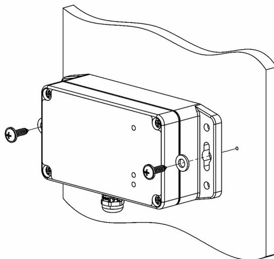
Рисунок 5 — Монтаж передающего блока на стену
