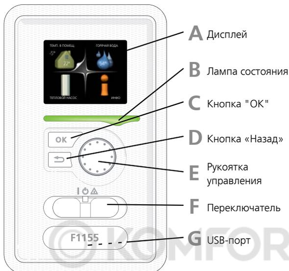
За дверцей теплового насоса имеется дисплей, используемый для связи с F1155. Здесь можно:
