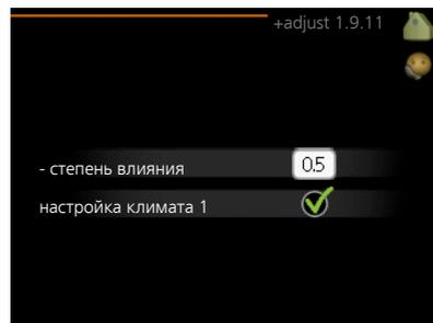
С помощью +Adjust выполняется обмен данными установки с центром управления подогрева пола\*, регулируется кривая нагрева и рассчитывается температура теплоносителя в зависимости от повторного подключения системы подогрева пола.
