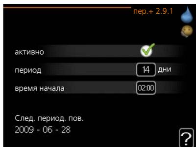
Для предотвращения размножения бактерий в водонагревателе компрессор и погружной нагреватель могут кратковременно повышать температуру горячей воды через регулярные промежутки времени.
