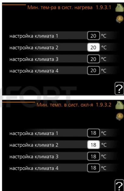
В меню 1.9.3 можно выбрать нагрев или охлаждение, в следующем меню (мин. температура подачи при нагреве/охлаждении) установите минимальную температуру подаваемого теплоносителя для системы климат-контроля. Это означает, что F1155 никогда не рассчитывает температуру ниже уставки.
