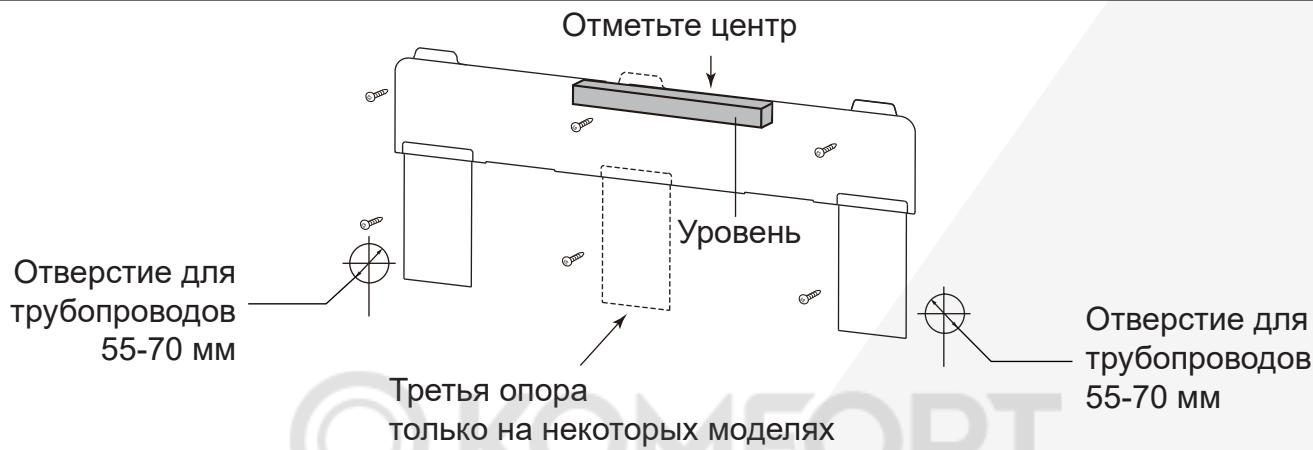
Выберите положение отверстия для трубопровода в соответствии с направлением труб. Отверстие для трубопровода должно быть немного ниже габарита станины внутреннего блока, как показано на рисунке.
