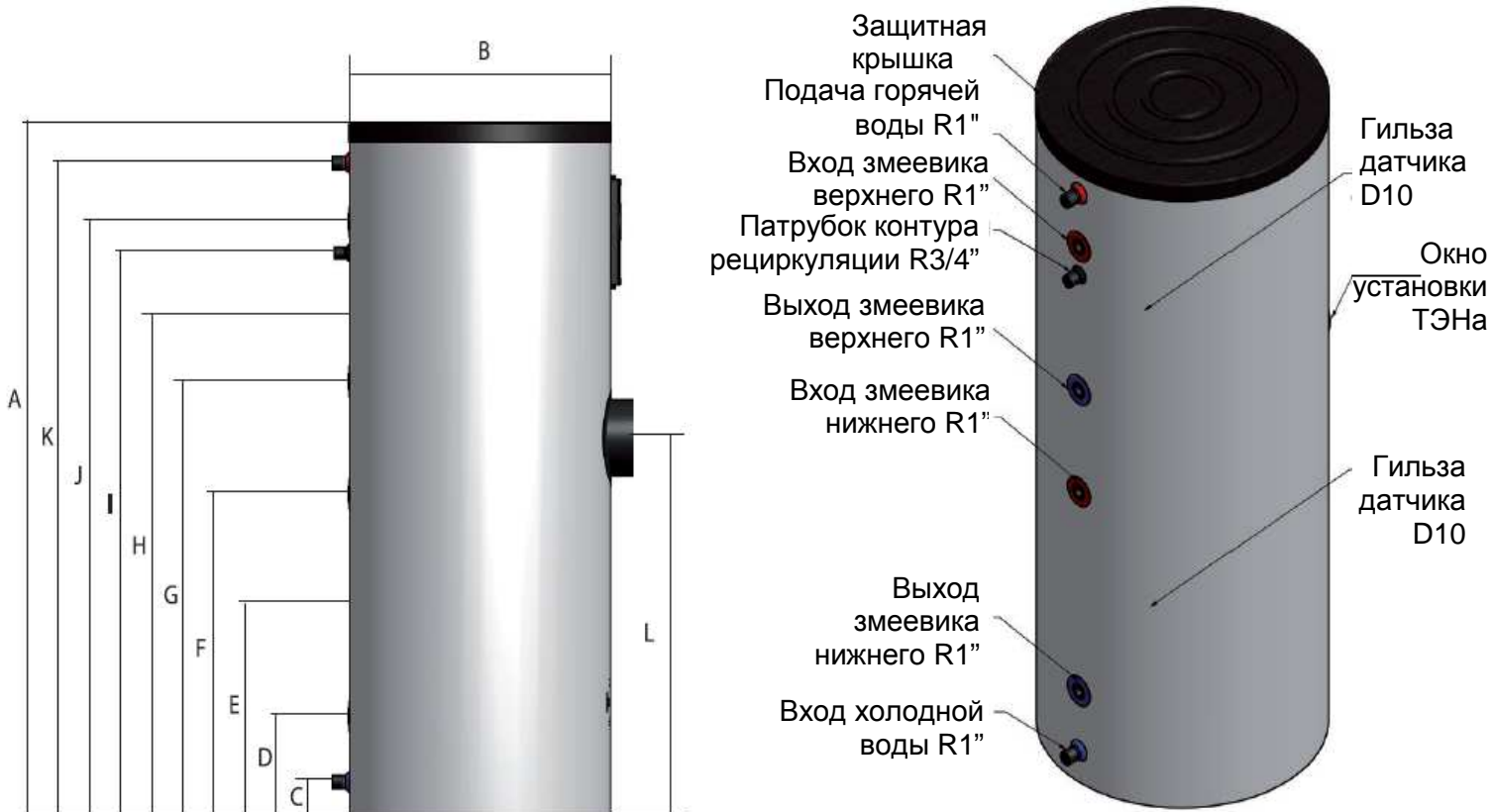
Водонагреватель с двумя теплообменниками-змеевиками 160-200 л
